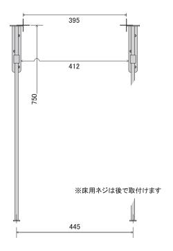
② 洗面器に固定金具を仮付けし、一度アングルに乗せ位置を調整する
