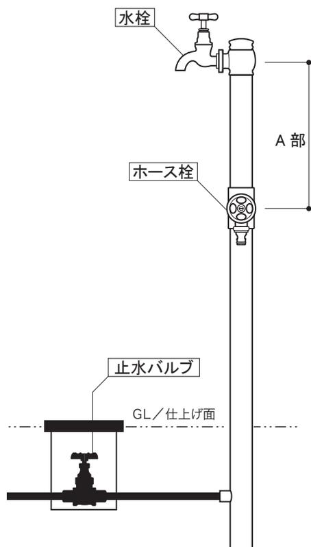
図解 ■ 近くに止水栓を設置する
