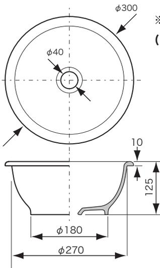
※天板の切込寸法は  $\phi 275\text{mm}$
