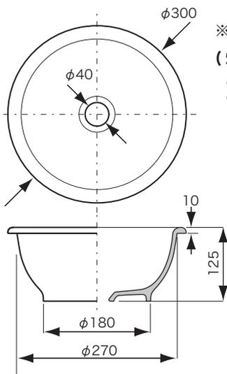
※天板の切込寸法は  $\phi 275\text{mm}$
